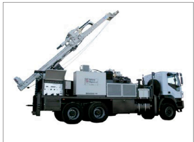
Figura 4.1. Máquina de perforación a rotoperCUSión montada sobre camión. (Fuente: Manual técnico para la ejecución de pozos, Gobierno de Canarias 2012)
